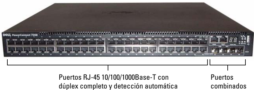
Ilustración 1-4. PowerConnect 7048 con 48 puertos 10/100/1000Base-T
