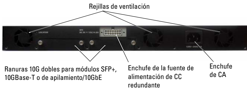
Ilustración 1-9. Panel posterior de PC7024P y PC7048P
